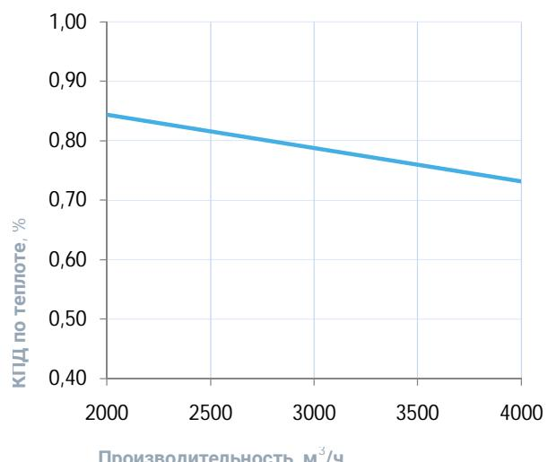
\* На вентхарактеристике указана производительность приточного канала. Производительность вытяжного канала может регулироваться от 70% до 120% приточного канала. КПД рекуператора показано для соотношения расходов воздуха 1:1.
