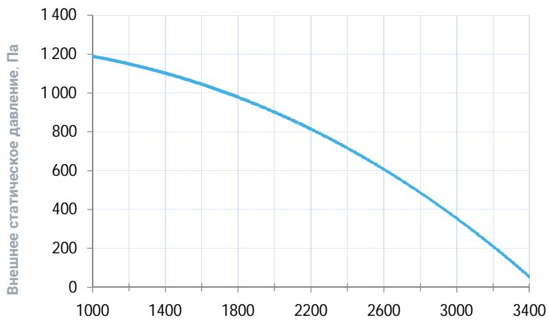
\* На вентхарктеристике указана производительность приточного канала. Производительность вытяжного канала может отличаться от 70% до 120% приточного канала. КПД вытяжного канала для соответствующих расходов различие 1-1,5%
